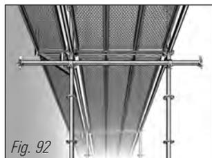
1. Acoplar la horizontal O con grapas en ambos verticales de modo que el cáncamo quede entre los labios la cabeza Allround.
