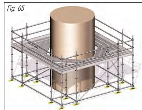
1. Colocar plataformas de acero tapando las esquinas interiores.
