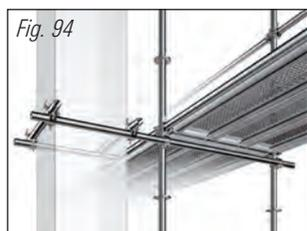
Los anclajes en apoyos de cemento o en apoyos de revestimientos se harán a través de construcciones de tubo y grapas. Apretar todas las grapas.
