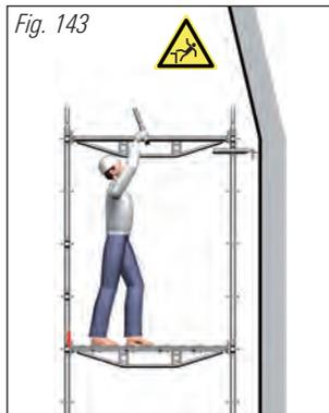
1. Montar el andamio (según capítulo 7 y 8), utilizando en dirección transversal vigas puente o de celosía.
