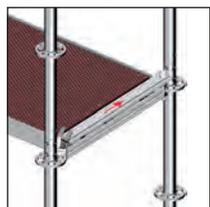
5. Abatir hacia abajo la parte móvil del cierre de seguridad.
