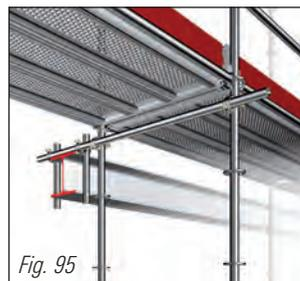
Anclaje a vigas horizontales a través de construcciones con tubo y grapa, en vigas de acero con ayuda de una grapa para perfil. Las secuencias de montaje corresponden a las mismas que se utilizan para anclajes en pilares o vigas de hormigón.
