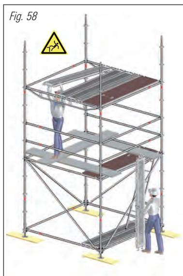
12. Colocar las plataformas de acceso junto con el resto de plataformas, y asegurarlas con el cierre de seguridad.
