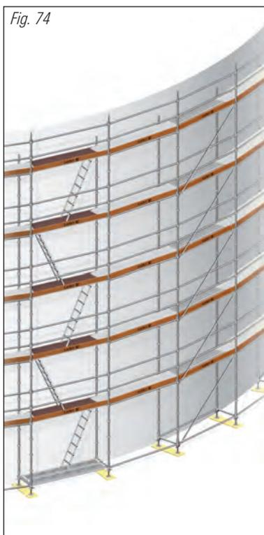
12. Repetir los pasos de montaje hasta alcanzar la altura deseada.
