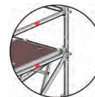
Fig. 87: Unión de verticales con espigas atornilladas
