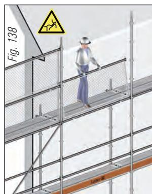
**Atención:** La variante de montaje mostrada en el dibujo sólo vale cuando en la parte externa del andamio se utiliza un vertical de 4 m. Si la vertical se coloca a la altura del nivel de trabajo, la unión tiene que ser reforzada mediante el acoplamiento de un tubo paralelo.
