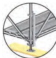
Fig. 85: Aseguramiento de base con cabeza con cuña
