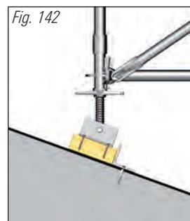
Los ajustes en superficies desniveladas se consiguen mediante la utilización de bases oscilantes.
