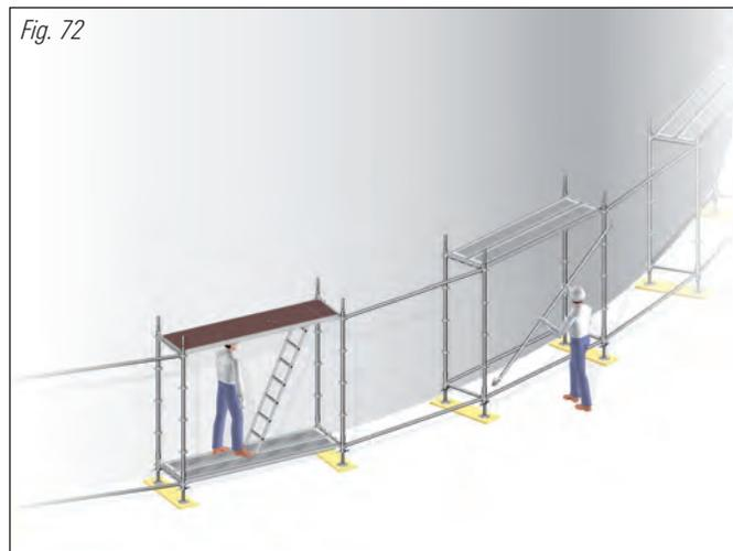
8. Montar las plataformas en los módulos rectangulares principales, cerrar el cierre de seguridad.
