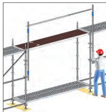
Fig. 38: Detalle del Montaje del MSG en el campo de subida.
