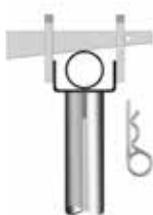
Detalle del soporte de la cubierta
